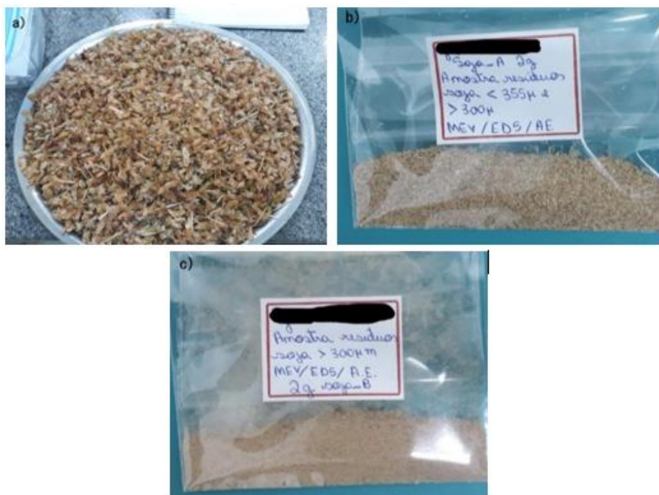
Figura 2. (a) Amostras dos resíduos da colheita de soja in natura (b) Granulometrias das amostras dos resíduos da colheita de soja com média \approx 328 \mu\text{m} e (c) Amostras dos resíduos da colheita de soja com granulometria \geq 300 \mu\text{m}
