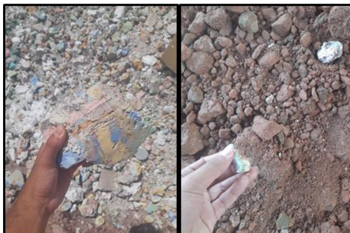
Figura 1a. Borra de tinta recém recebida pelo aterro Figura 1b. Borra de tinta incorporada ao traço de argila
