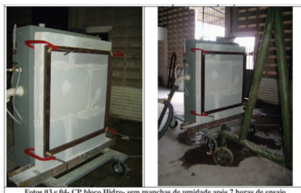
Fotos 03 e 04- CP' bloco Hidro- sem manchas de umidade após 7 horas de ensaio
