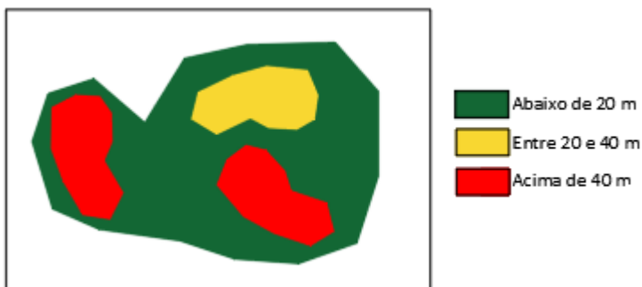
Figura 79 – Colorimetria altimétrica de um terreno.
