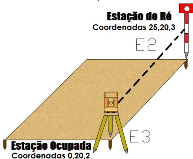
Figura 27 – Segunda estação em frente com o uso da estação total pelo método de levantamento por coordenadas.
