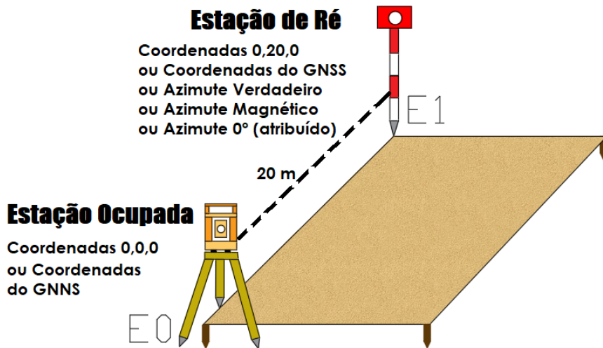
Figura 63- Levantamento por coordenadas.
