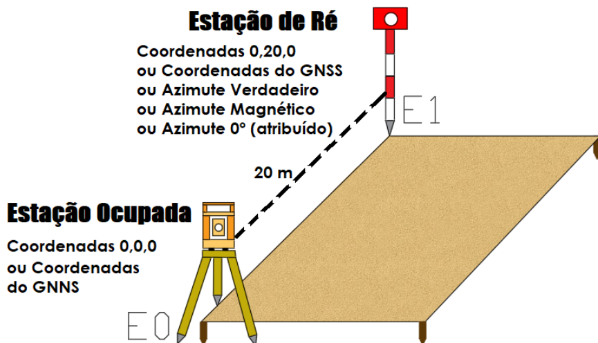
Figura 26 – Primeira estação com o uso da estação total pelo método de levantamento por coordenadas.
