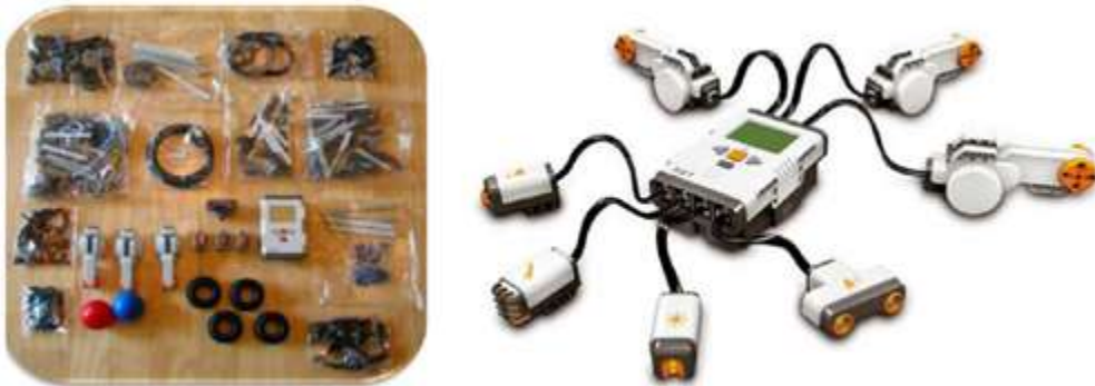
Figura 2 - Peças do kit e processador conectado a motores e sensores
